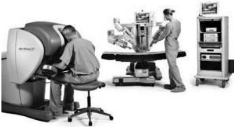
El sistema quirúrgico Da Vinci, creado por la firma californiana Intuitive Surgical, consta de brazos robóticos diseñados para la ejecución de cirugías mínimamente invasivas.
